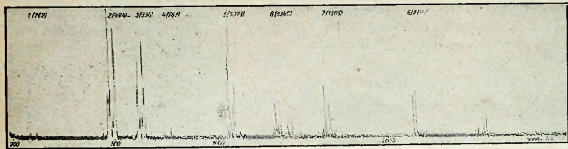
Fig. 9a. Klankspectrum van een klok uit een klokkenspel, opgenomen met een condensatormicrofoon.
